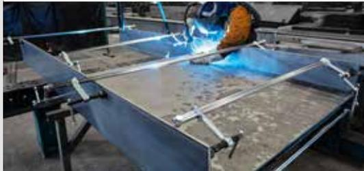
BESSEY bietet neben komplett montierten Hochleistungszwingen-Sets auch vielseitig miteinander kombinierbares Zubehör an. Bereits aufgesteckte Gleitbügel können von Spannen auf Spreizen umgesteckt oder durch andere Gleitbügel ersetzt aber auch um weitere ergänzt werden.
