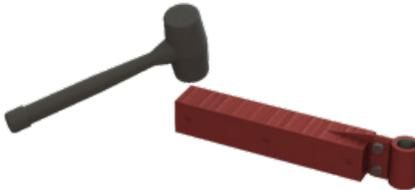
4. Mettez en marche l'appareil de chauffe en appuyant sur **START**. Le barreau se positionne à présent. Si nécessaire, un marteau (à amortisseur) en plastique peut être utilisé.
