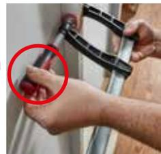
**Зажим деталей, расположенных вплотную к примыкающей поверхности,** не представляется возможным из-за неудобного положения ручки в классических винтовых или рычажных струбцинах, поскольку с ручкой не получается проводить какие-либо манипуляции.
