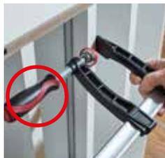
**Зажим деталей на узком участке** может вызвать проблемы в использовании классических винтовых и рычажных струбцин, поскольку их ручки мешают нужному расположению инструментов.
