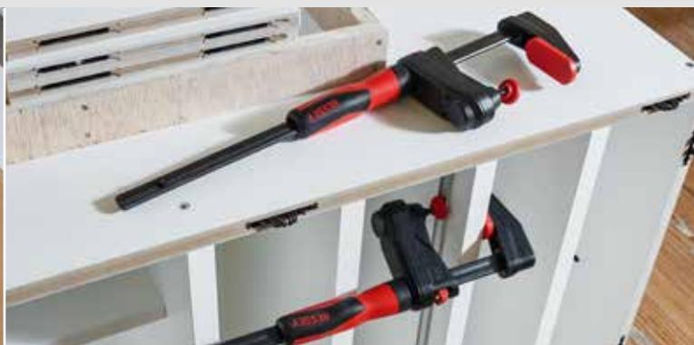
Фирма BESSEY представила мировую новинку – струбцину с редуктором GearKlamp GK. Эта струбцина даёт отличную возможность легко и просто фиксировать детали даже в очень ограниченном пространстве. Её можно запросто использовать в местах, которые до настоящего времени считались недоступными или были труднодоступны для использования зажимных инструментов.
